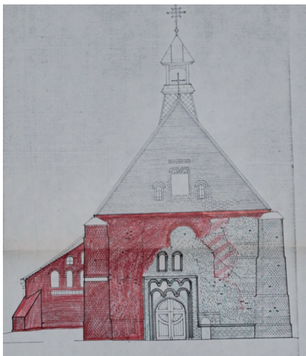
Rys. 2. Kościół parafialny w Pawłowie Kościelnym. Widok (rekonstrukcja stanu z ok. 1548 r.) elewacji zachodniej – fasady. Prawa część fasady – odtworzenie po 1538 r. (niemal stan dzisiejszy)
